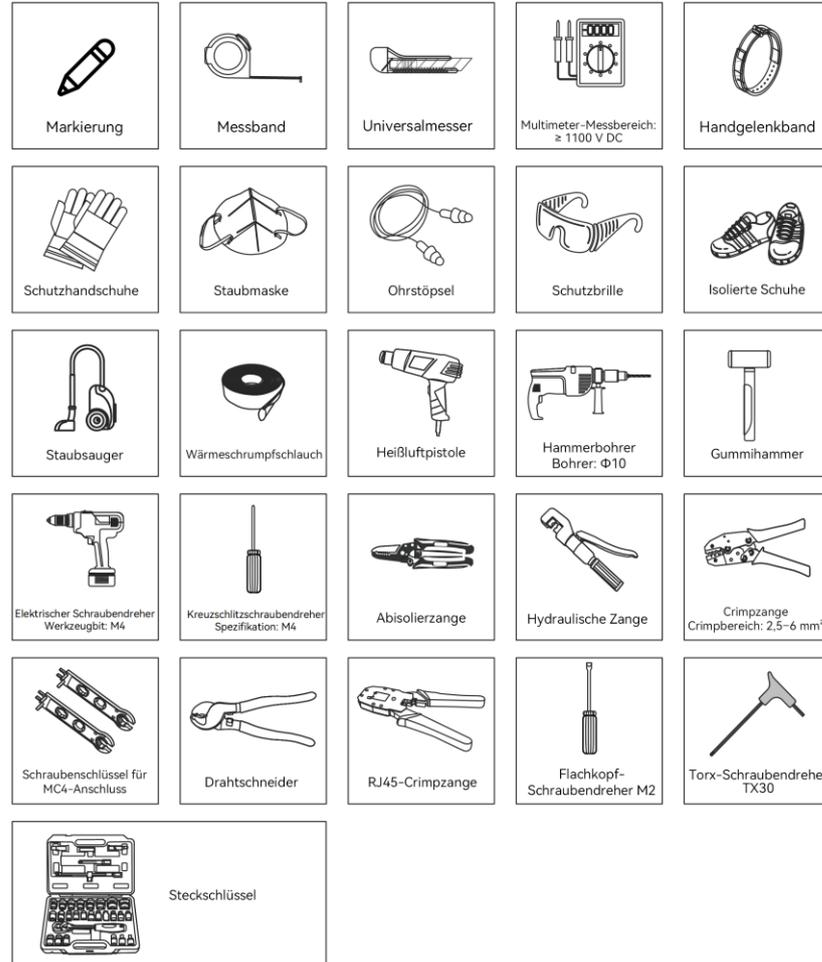
Abbildung 4.5. Empfohlene Installationswerkzeuge
